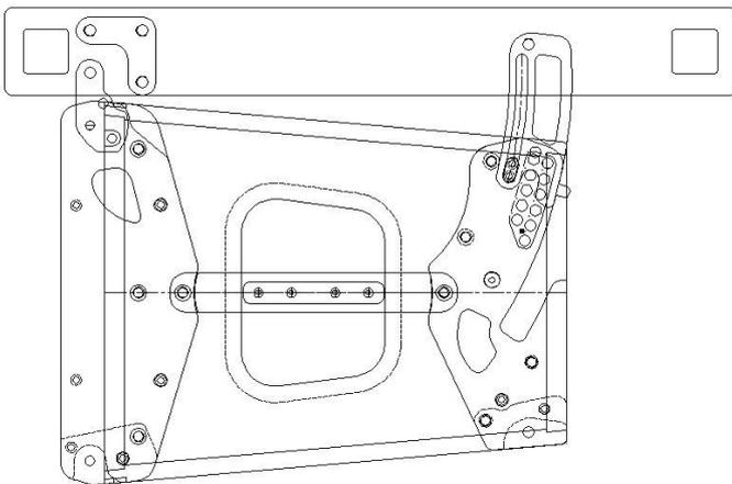
*Fijación del bumper para usar en formato estacado.*
